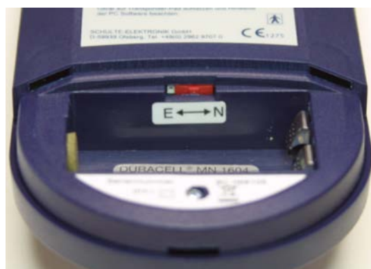
Bild 4: Batterifack: omkopplare för registreringskänslighet
