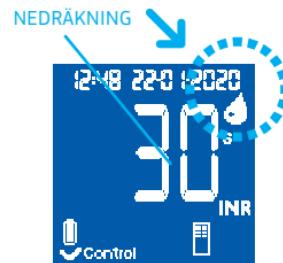
Om du applicerat provet och inget ljud hörs, är provvolymen inte tillräcklig. Ta bort Chip och gör om testet med ett nytt Chip. Se till att storleken på droppen är tillräcklig och att ingångskanalen inte blockeras när droppen sugs in.
