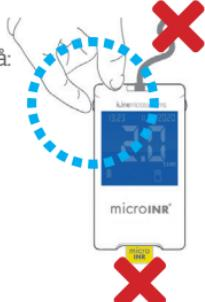
Måleapparatet kan ikke slukkes, mens det er tilsluttet strømforsyningen.
