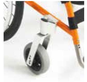
Länkhjulsupphängning för stabilitet och prestanda.
