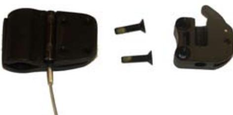
Skruga bort låsdelen (till höger på bilden) från originalfästet (4mm Insexnyckel). Dessa skruvar skall användas vid montering på det nya beslaget. Skruva av väjern till låssprinten om denna skall användas.
