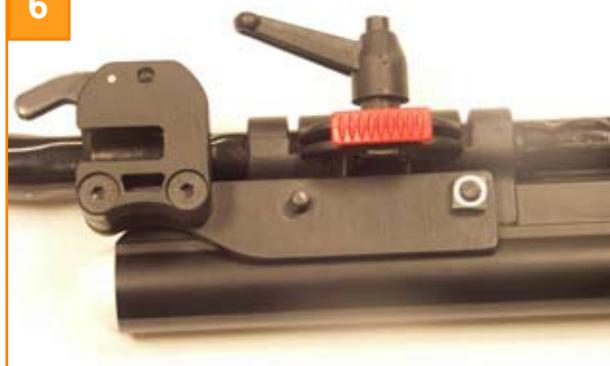
Sätt dit fästena, med låsdelen, på insidan av rygrören med de längre svarta skruvarna, som levererats med fästena. Den rundade sidan skall vara framåt. Sätt dit muttrarna, som togs bort i moment 5, använd gänglåsning. Om låssprinten ska användas måste öglan borras upp med 6 mm borrh och fästas i ovan nämnda skruvar.
