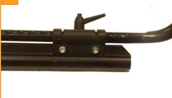
Ta bort skruvarna som håller körhandtagen. Spara på de fyrkantiga muttrarna.
