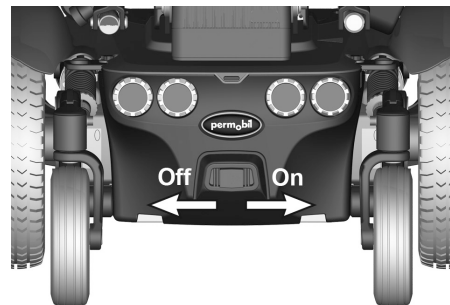
Bild 120. Återställning av huvudsäkring/batterifrånskiljare.
