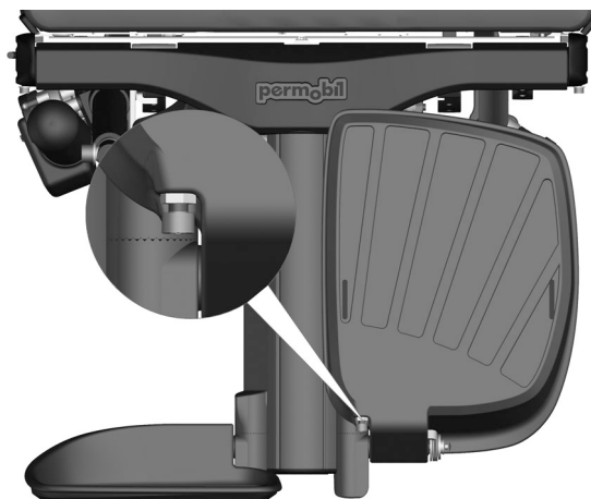
Bild 19. Fotplattornas vinkel kan justeras med hjälp av en skruv som fixeras med en kontramutter.
