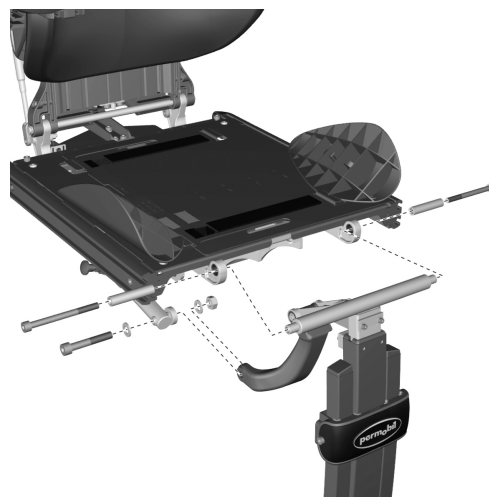
Bild 113. Benstödet sitter monterat med två skruvar och distanser. Det främre fästet på den manuella justeringsenheten är monterat med skruv och kontramutter.
