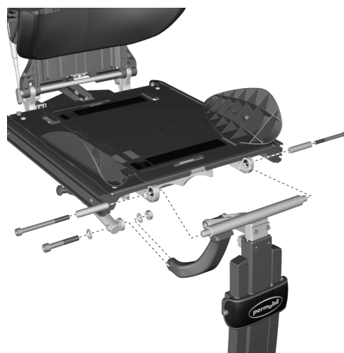
Bild 112. Benstödet sitter monterat med två skruvar och distanser. Det främre fästet på ställdonets manuella justeringsenhet är monterat med skruv och kontramutter.
