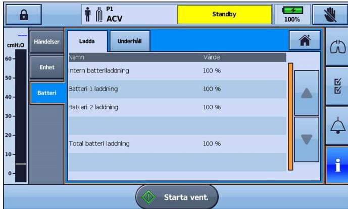
Kontrollera laddningsnivån för det interna batteriet och alla ansluta externa batterier regelbundet. Det rekommenderas att byta ut alla batterier vid 400 laddningscykler.
