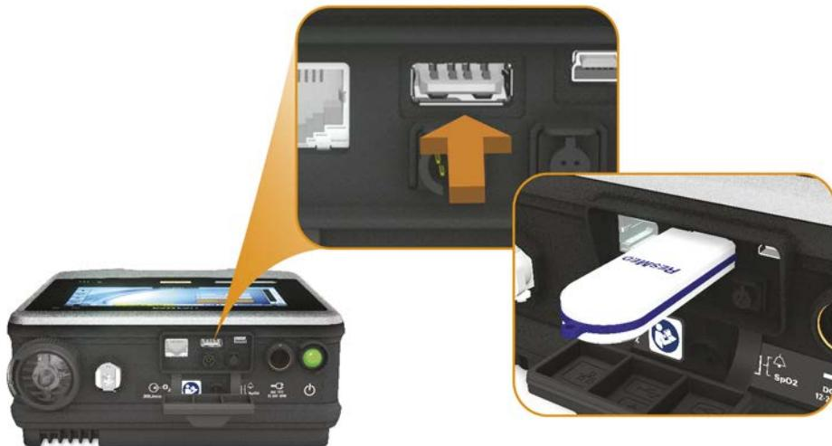
USB-nøglen fjernes ved blot at trække den ud af USB-stikket, når overførslen er færdig. Hvis dataoverførsel var i gang på det tidspunkt, advarer en meddeelse i informationslinjen om en mislykket overførsel.
