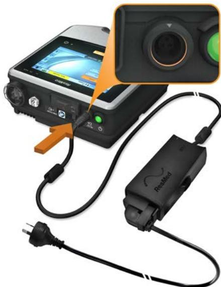
**Bemærk:** El-ledningen er forsynet med et træk-skub låsende stik. Den fjernes ved at gribe fat i el-ledningens hoved og forsigtigt trække stikket væk fra apparatet. Undlad at dreje det udvendige af stikket eller at trække i ledningen.
