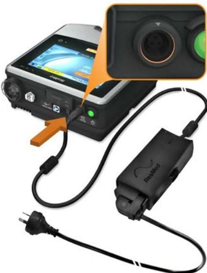
Merk: Strømledningen er utstyrt med en skyve/trekke-låsekobling. Den fjernes ved å ta tak i strømledningshuset og forsiktig trekke koblingen fra apparatet. Ikke vri det ytre huset eller trekk i ledningen.
