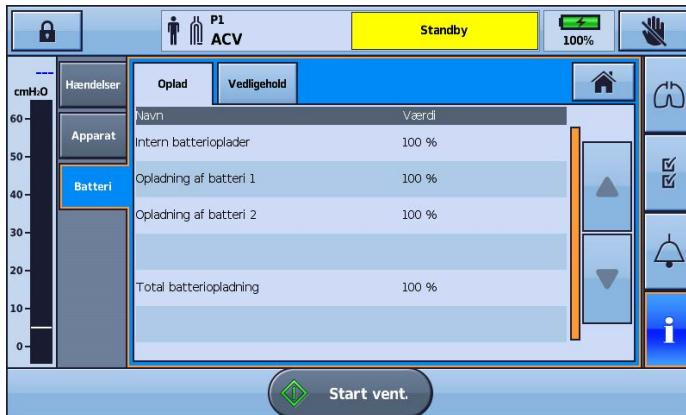
Kontrollér jævnligt opladningsniveauet for det interne batteri og for eventuelt tilsluttede eksterne batterier. Det anbefales, at batterier udskiftes efter 400 opladningscyklusser.
