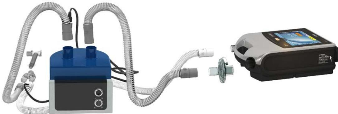
Vid användning av uppvärmd befuktning med en dubbel krets, kan kondensation bildas i sensorn för utandningsflöde om luften kyls till under dess daggpunkt. Kondensation kan även bildas i patientkretsen och bildas mest sannolikt vid höga befuktningstillställningar och låga omgivningstemperaturer.
