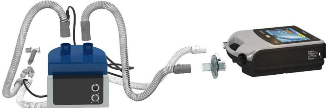
Ved bruk av oppvarmet fukting med en dobbeltkrets, kan det danne seg kondensering i ekspirasjonsflowsensoren hvis luften avkjøles til under dets dugpunkt. Det kan også danne seg kondensering i pasientkretsen og det er meget sannsynlig at dette dannes ved høye fuktinnstillingar og lave omgivelsestemperaturer.
