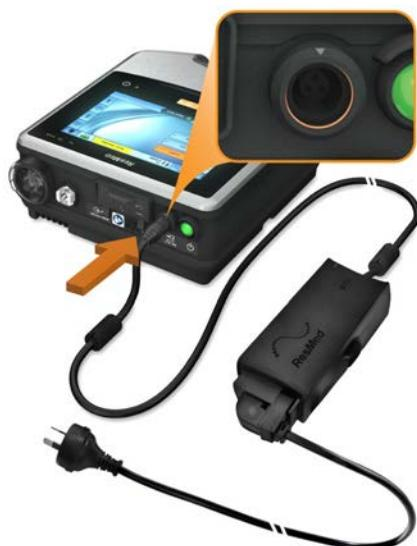
**Huomautus:** Virtajohdossa on push-pull-lukitusliitin. Irrota virtajohto tarttumalla virtajohdon kotelosta ja vetämällä liitin varovasti laitteesta. Johdon ulkosuojusta ei saa väänntää eikä johdosta saa vetää.
