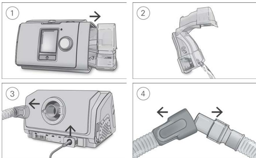
1. Hold foroven og forneden på fugteren, tryk forsigtigt på den, og træk den væk fra apparatet.
