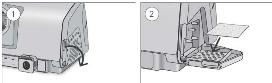
1. Öppna luftfilterlocket och avlägsna det gamla luftfiltret.
