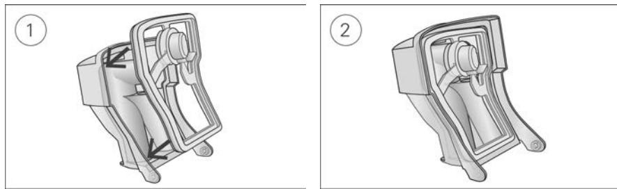
1. Do víka vložte těsnění.
