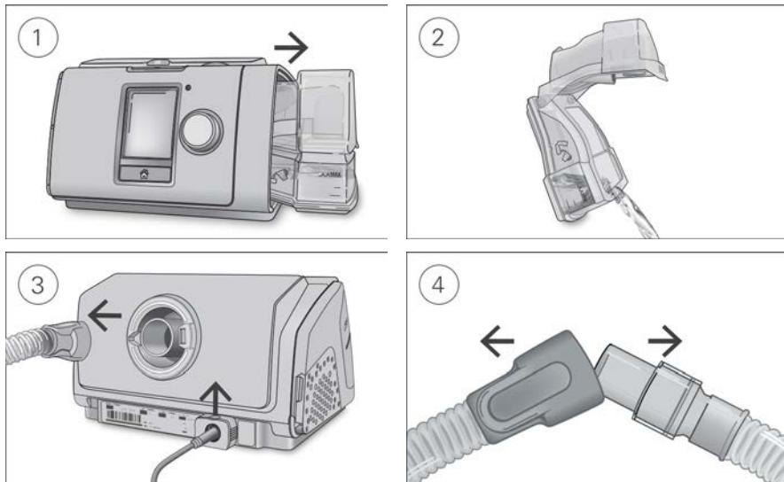
1. Pidä kiinni kostuttimen ylä- ja alaosasta, purista varovasti ja vedä kostutin irti laitteesta.
