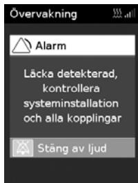
När ett alarm är aktiverat, kommer den gula lysdiodsindikatorn att blinka, alarmet ljudar och ett meddelande kommer att synas på skärmen.
