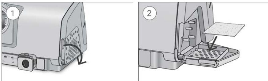
1. Åpne luftfilterdekselet og ta ut det gamle luftfilteret.
