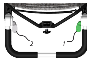
Figur 14. Reglage för sitstilt (1) och ryggfällning (2).
