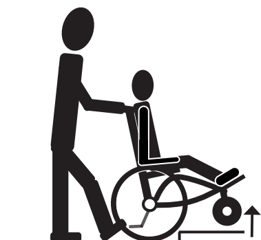
Trampa ned trampröret
