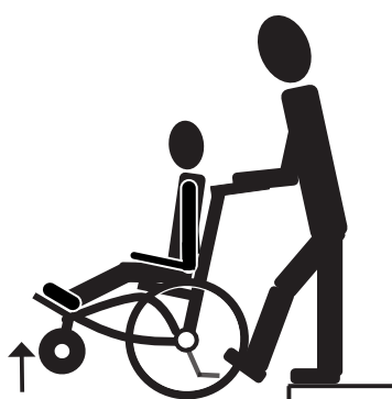
Trampa ned trampröret
