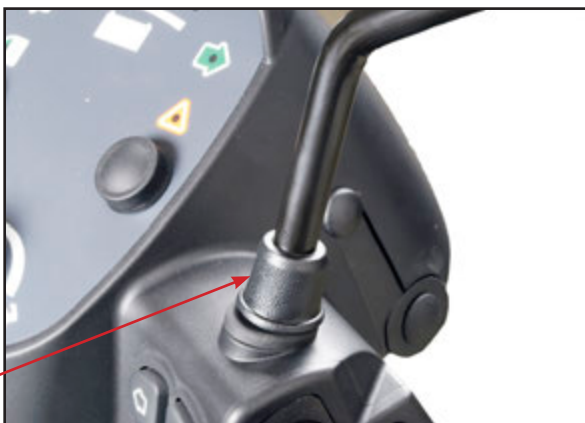
Spegeln skruvas på. Innan den skruvats i botten, skall man hitta en lämplig placering. I den placeringen dras kontramuttern åt.
