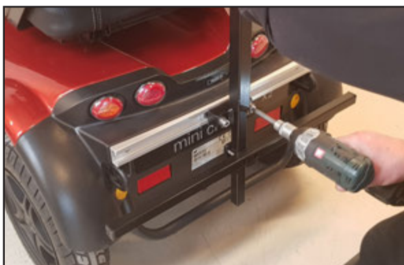
Skruva fast rollatorhållaren.
