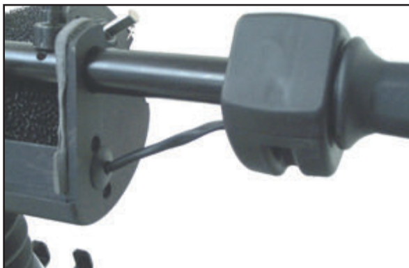
Montera vridgasreglaget på styret.
