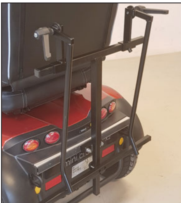
Mät hur långt stycke som ska användas av gummilisten på vardera sidan av rollatorhållaren.
