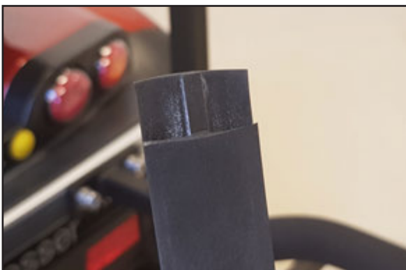
Baksidan av gummlisten klipps av i en längd av ca 10 mm i båda ändarna. Detta görs för att få en fin ände.
