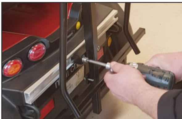
Placera Rullstolshållaren på mitten av C-skenan. Dra åt.
