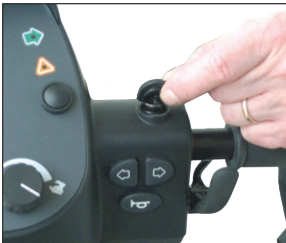
Tag gummitätningen av spegelfästet på styret.
