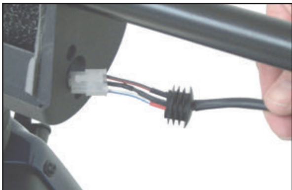
Kontakt och plugg monteras i hålet.
