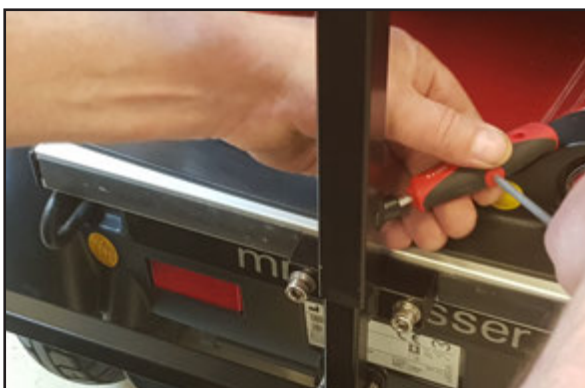
För att justera den översta delen - lossa denna skruv.
