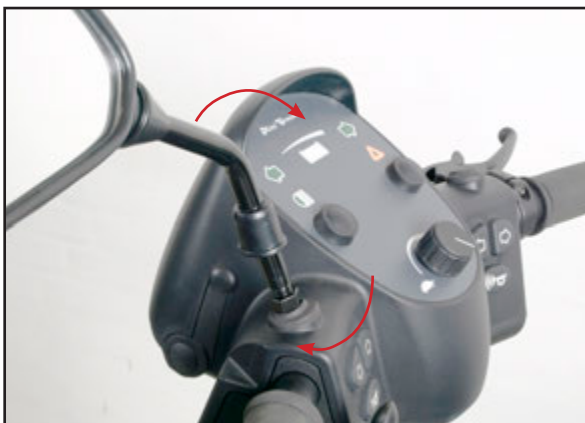
Spegeln skruvas på. Innan den skruvats i botten, skall man hitta en lämplig placering. I den placeringen dras kontramuttern åt.
