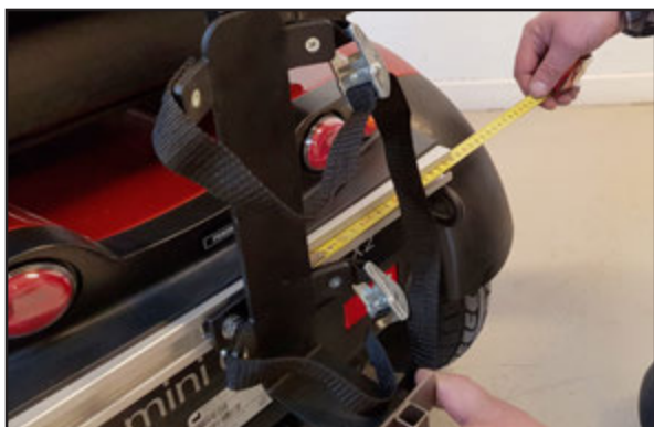
Kontrollera att måtten till båda sidor är samma. Så sitter flaskan i mitten.
