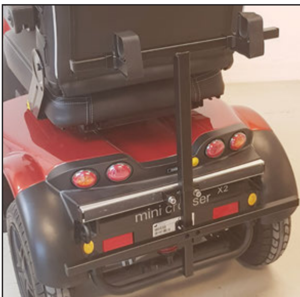
Mät hur långt stycke som ska användas av gummilisten på vardera sidan av rollatorhållaren.
