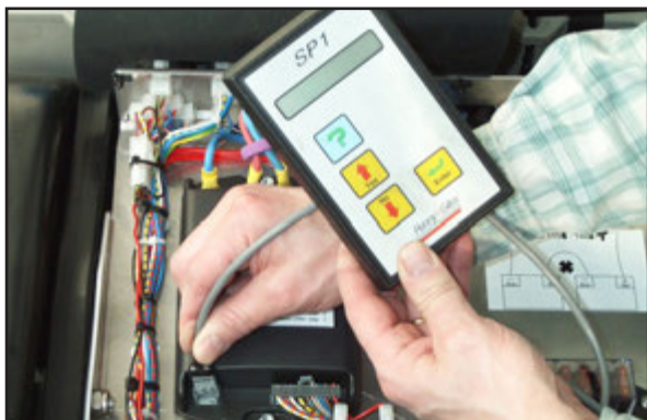
Programmeringen ändras till "Single-ended" via SP1, SP2 eller dator. Se separat beskrivning för programmering.
