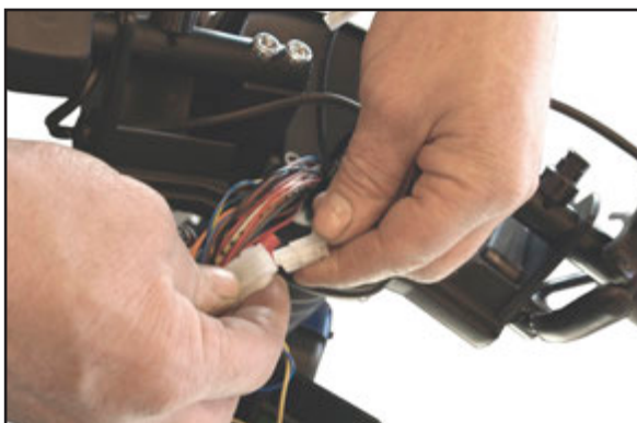
Anslut drivgasreglaget till den 3-pols-kontakt som standardpotentiometern var ansluten till.
