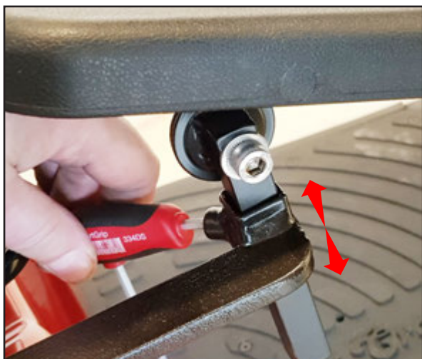
Justering av höjd på amputationsbenstödet: Lossa denna skruv - höj/sänk till önskad höjd - spänn skruven igen.
