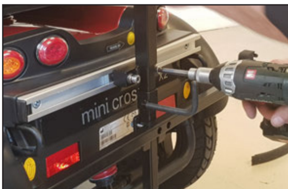
Skruva fast rollatorhållaren.
