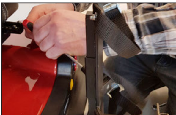
Staget nederst kan justeras upp/ned genom att lossa de två skruvarna - justera till önskad position - dra åt skruvarna igen.
