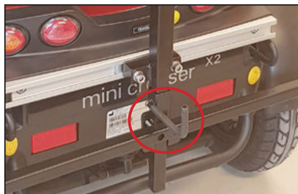
Justering av nedersta staget: Lossa denna skruv - justera till önskad höjd - dra åt igen.
