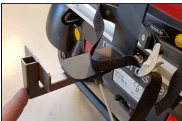
Justera för flaskans diameter. Lossa denna skruv - ställ in önskad storlek - dra åt igen.
