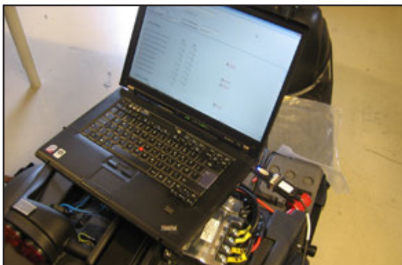
Programmeringen ändras till "Single-ended" via SP1, SP2 eller dator. Se separat beskrivning för programmering.
