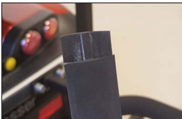
Baksidan av gummilisten klipps av i en längd av ca 10 mm i båda ändarna. Detta görs för att få en fin ände.
