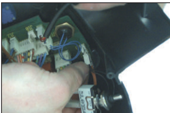
Anslut till kontakt nr 2 på kretskortet. Montera de små crimpsen i kontakten, så att färgerna mittemot varandra matchar.
