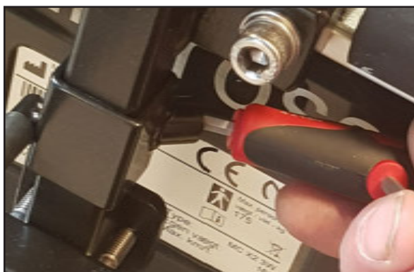
Justering av nedersta staget: Lossa denna skruv - justera till önskad höjd - dra åt igen.
