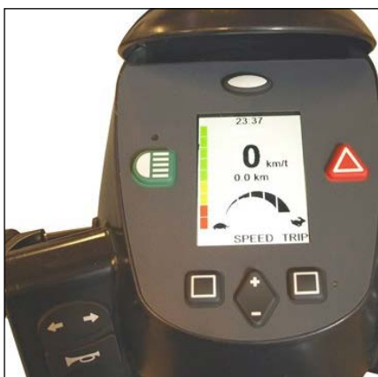
Kurvsänkning 1506-1844 - Kurvsänkning 3W 1506-2060 - Kurvsänkning 4W Kurvsänkning kan automatiskt justera ner farten vid svängar.
