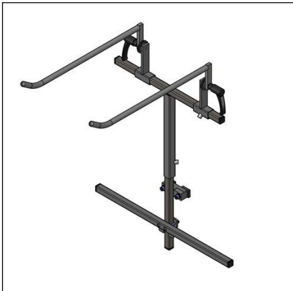
Hållare för manuell rullstol, bakmonterad 1506-1263 - bakmonterad i c-skene Passar kryssrams stolar. Justerbar i höjden (manuellt). Medar (hängkrokar) justerbara i bredd och vinkel. Kan vinklas ner när de ej används.
