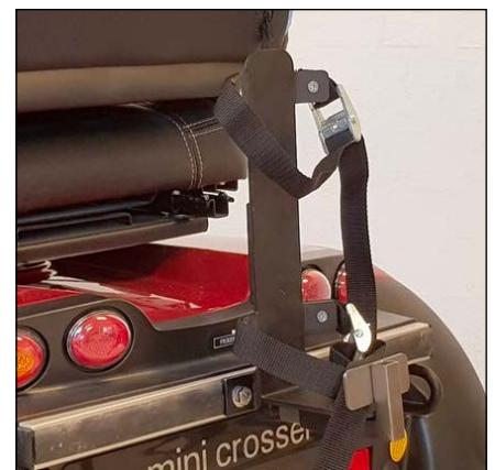
Syrgashållare Universal MC X 1506-2097 - Justerbar för flaskans diameter.
