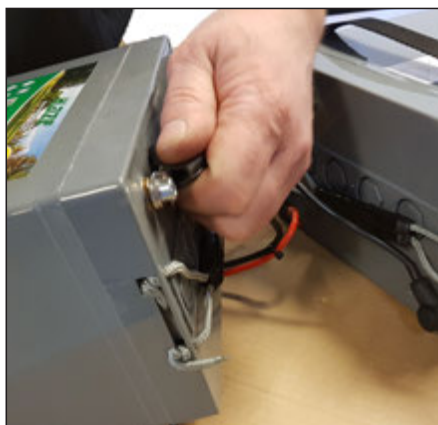
Lossa polskorna på de gamla batterierna och montera på de nya
