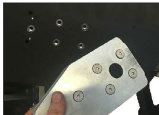
De medföljande skruvarna placeras i låsplattan, och skruvas upp i muttrarna.
