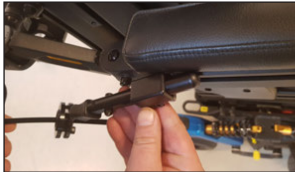
Lossa C-skenemuttrarna så det är möjligt att montera dem i C-skenan på armstödet.
