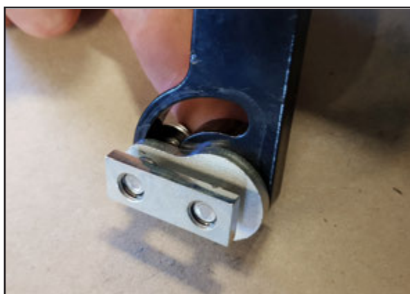
Lossa skruvarna lite så beslaget kan glida in i c-skenan.
