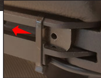
Montera C-skene-muttrarna i armstödet C-skena.
