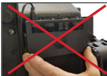
Om sätet är inställt till 45cm eller mera, är det plats till att montera R-net Omni-2 Input sektionen inne i sätesryggen.
