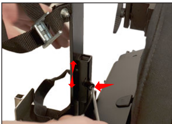
Justeras upp/ned genom att lossa denna skruv - justera och spänn fast igen.
