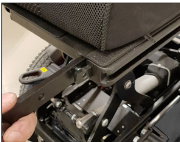
Lossa C-skene muttrarna och skjut in dem i den inre C-skenan på stolen.
