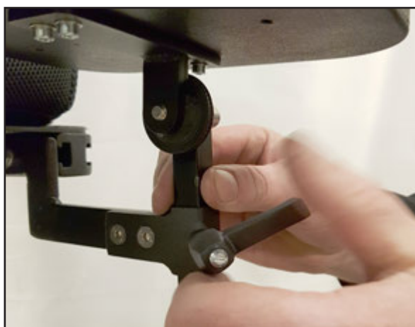
Justering upp/ner görs genom att lossa låsspaken- justera och spänn till igen.
