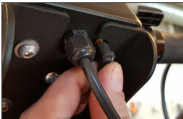
Knappboxens kabel kopplas till ledsagarstyrningen här.
