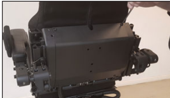
Börja med att montera av ryggplattan på Spinalus-2 sätet. (4 skruvar)
