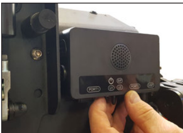
Om sätet är inställt till 40 cm måste R-net Omni-2 Input sektionen monteras utanpå sätesryggen.
