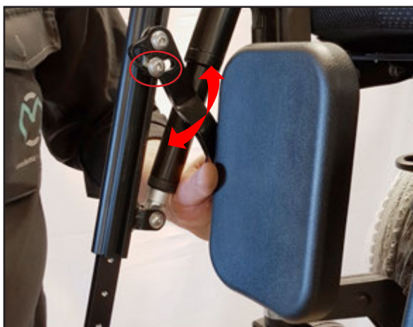
När båda skruvarna är lösa, kan både höjd och vinkel justeras. När bara den nedre skruven är lös, kan vinkeln justeras.
