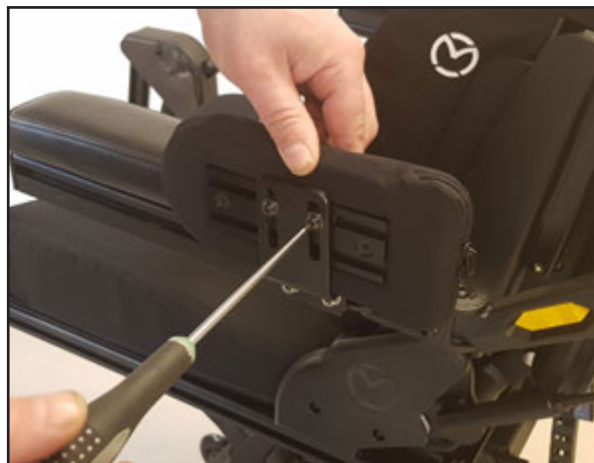
De mindre skruvarna och brickorna passar till C-skene-muttrarna i sidostöden för armstödet.
