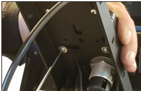
Montera knappboxen med de medföljande skruven.
