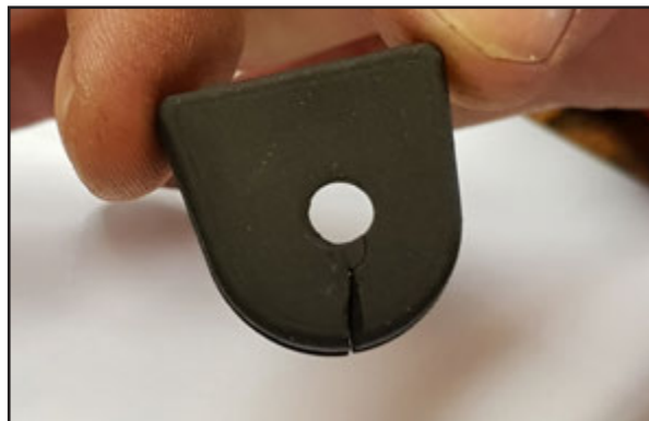
Det görs hål för kabeln i de två genomföringarna. Klipp en slits från toppen av rundningen till hålet.
