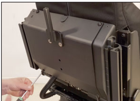
Bakplattan monteras på stolen igen.
