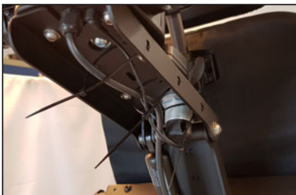
Sätt stripes om de två kablarna. Dra inte åt dem ännu.
