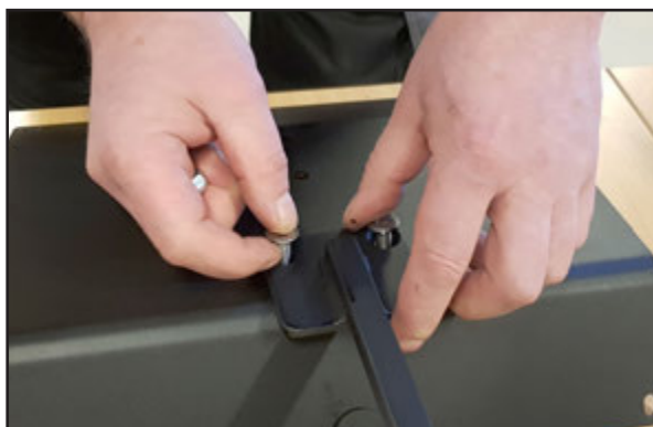
Placera beslaget med de försänkta skruvarna i de förborrade hålen.
