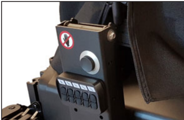
Om man valt att koppla till knappboxen placeras den här.
