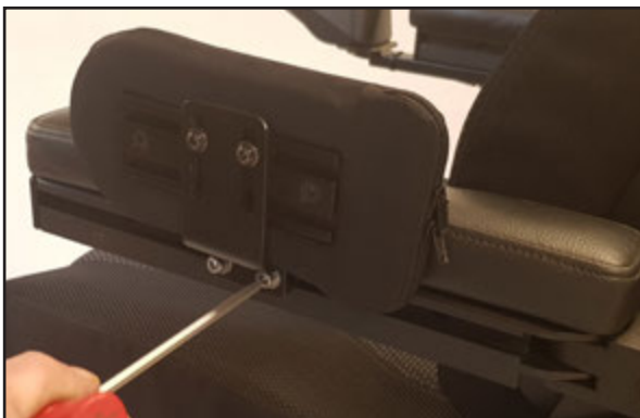
De större skruvarna och brickorna används till att montera beslaget på C-skene-muttrarna.
