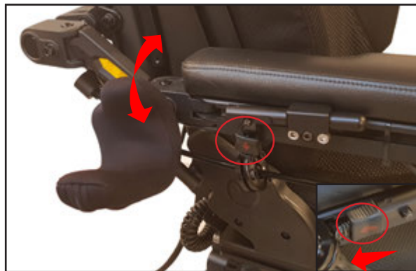
Armbågsstödet kan fällas ner genom att dra utlösaren bakåt och skjuta stödet bakåt.
