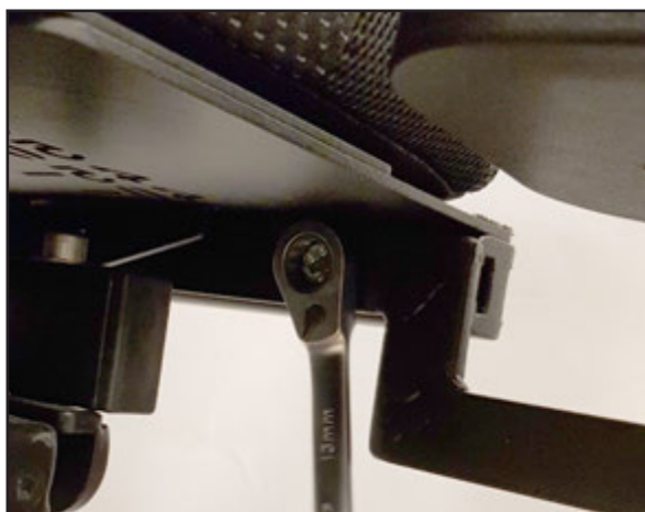
Dra åt skruvarna. Verktyg: Fastnyckel 13 mm
