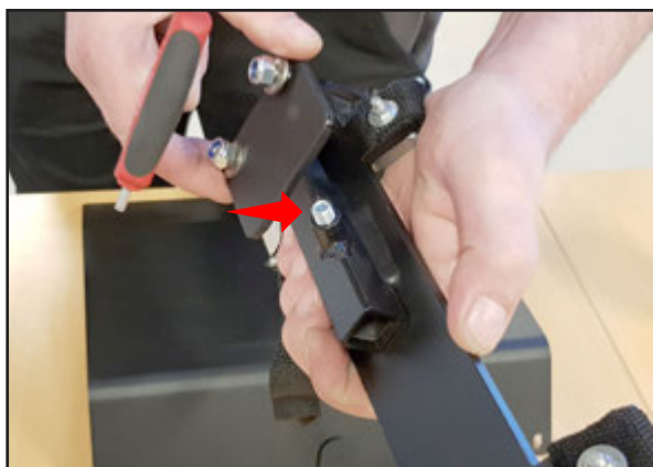
Montera av beslaget genom att lossa denna skruv.
