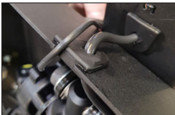
För kabeln igenom kabelgenomförningen och anslut till R-net Omni-2 Display sektionen.
