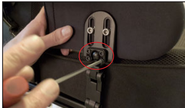
Genom att lossa skruvarna vid kulleiden kan man vända och ställa in stödet i alla riktningar. Dra åt igen efter justering.
