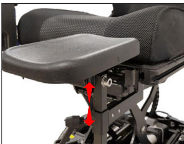
Justering upp/ner görs genom att lossa låsspaken- justera och spänn till igen.
