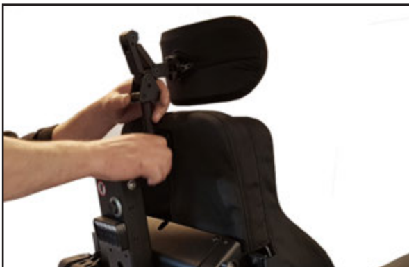
Montera även bort nackstöd om det finns.
