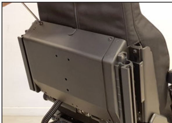
Börja med att montera av bakplattan på Spinalus-2
