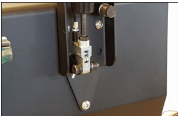
Montera ledsagarstyrningen på den lösa ryggplattan med medföljande skruvar.
