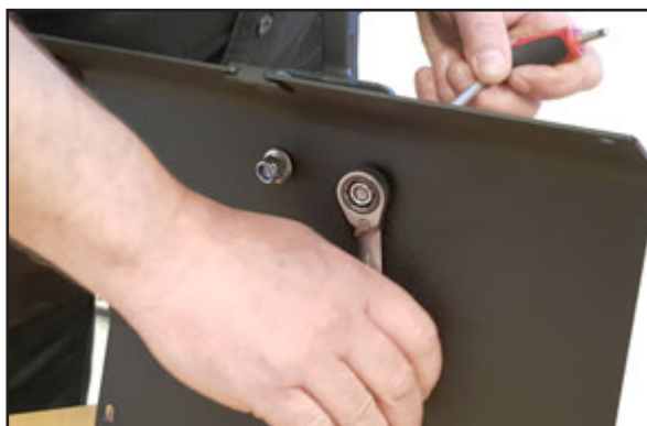
Skivor och låsmuttras monteras och skruvas fast. Verktyg: Insexnyckel 6 + fastnyckel 13.
