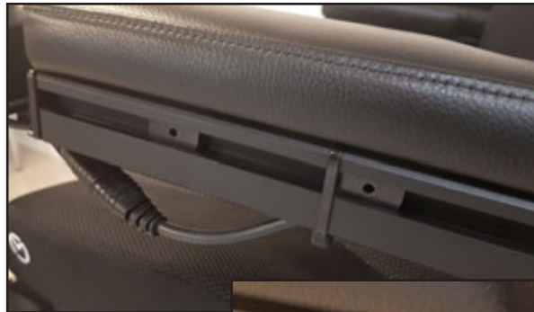
Montera C-skene-muttrarna i armstödet C-skena.
