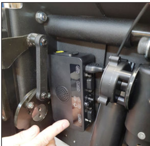
Om sätet är inställt till 45cm eller mera, är det plats till att montera R-net Omni-2 Input sektionen inne i sätesryggen.
