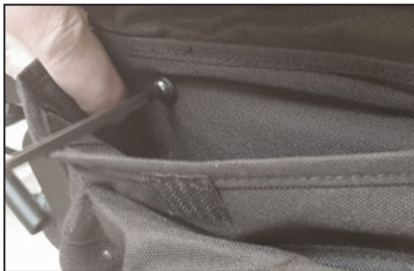
Drag lite i väskan så att den rätas helt ut innan den sista skruven sätts fast.
