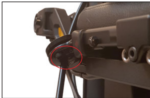
Justering upp/ned: Lossa skruvarna här - justera till önskad höjd - dra åt skruvarna igen.
