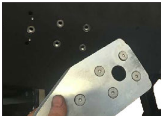
De medföljande skruvarna placeras i låsplattan, och skruvas upp i muttrarna.
