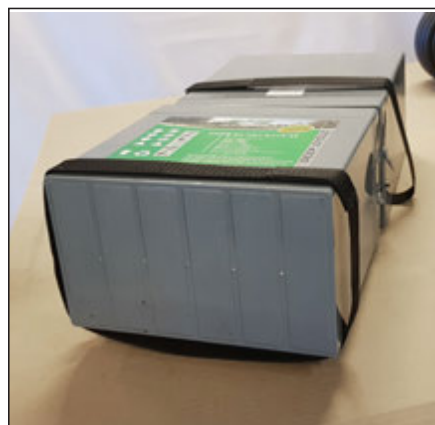
Lägg batterierna med polerna mot varandra
