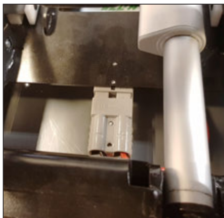
Förbind kontakten igen, med att styra/trycka med det röda handtaget.
