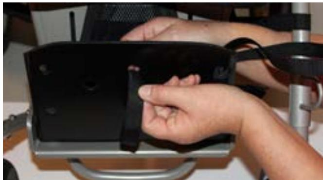
4) Trä upp remmen i främre hålet, underifrån. / Insert the straps in the front hole in the foot plate, from below.
