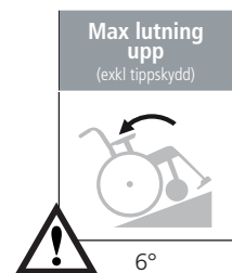
Stolen kan tippa om lutningen bakåt är större än 6°. Använd tippskydd!
